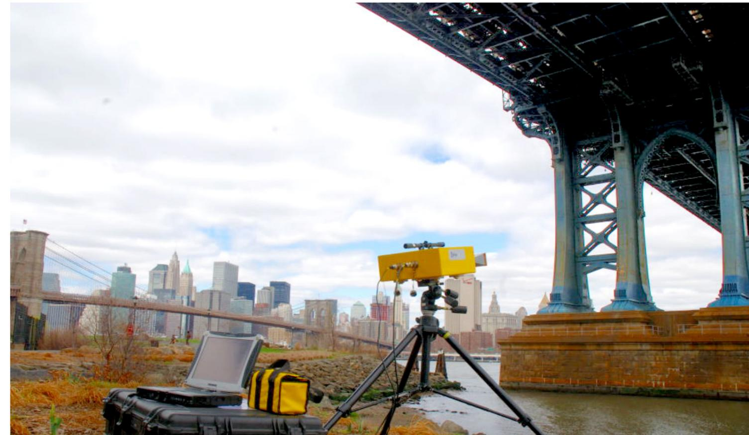
IBIS-FS: REAL TIME VIBRATION ANALYSIS UTILIZING MICROWAVE INTERFEROMETRY
